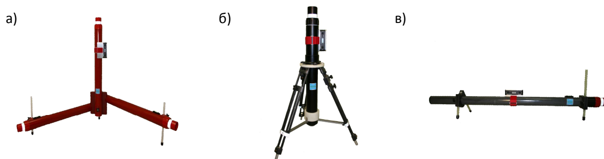
Рис. 3. Схема расстановки магнитотеллурической станции МТЗ-АМТ в 5-ти канальном варианте. а - схема установки для полевых наблюдений методами МТЗ-АМТ и МВП, б – общий вид магнитных датчиков для АМТЗ, установленных на прецизионной треноге, с – один из способов транспортировки треноги и магнитных датчиков - заплечная станина (открытый рюкзак). Цифрами обозначено: 1 – станция МТУ-5А; 2 – магнитные датчики; 3 – GPS антенна; 4 – неполяризуемые электроды; 5 – аккумуляторная батарея; 6 – азимут установки.
